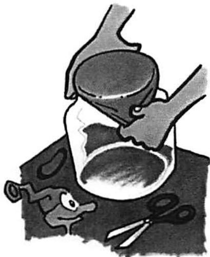
1. Avec les ciseaux, coupe le ballon de façon à obtenir une membrane pour recouvrir l'ouverture du pot en verre. Fixe la membrane au pot avec l'élastique.
